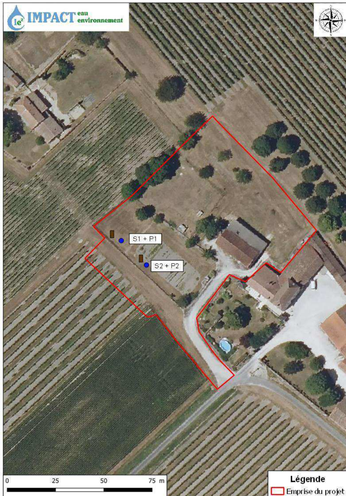
Figure 5. Localisation des essais de perméabilité
